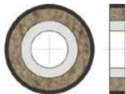
Керамический корпус с вклеенным стальным кольцом
